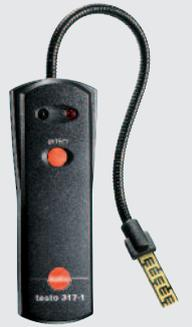
El detector de fugas de gases de combustión testo 317-1 localiza de forma eficaz los escapes de humos en unidades de calefacción. El práctico instrumento activa inmediatamente una alarma visual y acústica, haciendo innecesaria la inspección visual. El cuello maleable facilita el uso en puntos de difícil acceso.
