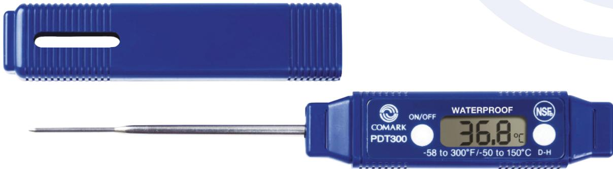
El termómetro impermeable PDT300 de Comark tiene un tiempo de respuesta rápido de seis segundos o menos y tiene un perfil delgado que se ajusta a la altura en el bolsillo
