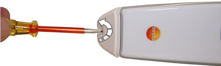
1. Soltar el tornillo del compartimiento de las pilas.
